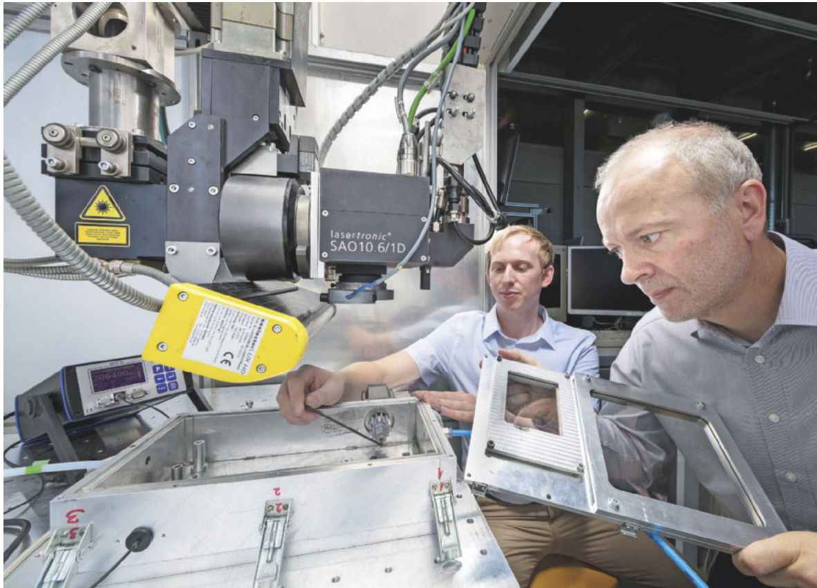
Laser statt Lappen: Harald Riegel (rechts), Leiter des Laser-Applikationszentrums, und Doktorand Simon Ruck reinigen im Labor die Oberfläche gedruckter Bauteile. Dazu nutzen die beiden Aalener Forscher das Licht eines Lasers.
