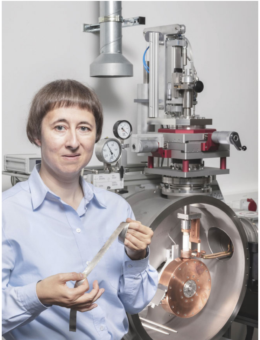
Dagmar Goll ist neuen magnetischen Werkstoffen mit besonderen Eigenschaften auf der Spur. Das Metallband, das sie in den Händen hält, wurde an der Schmelzspinnanlage im Hintergrund gefertigt.
