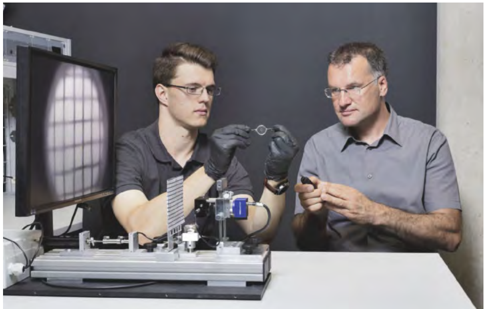
Optik auf dem Teststand: Sebastian Hägele und Andreas Heinrich (rechts) prüfen Abbildungseigenschaften und Lichtstreuung einer dreidimensional gedruckten Flüssiglinse.
