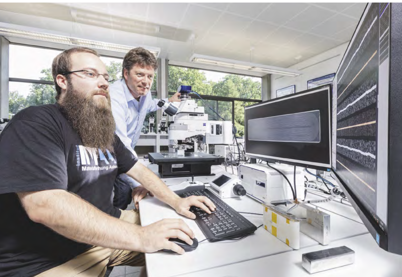
Um prismenförmige Lithium-Ionen-Zellen zu charakterisieren, nutzen Andreas Jansche und Timo Bernthaler (rechts) die Aufnahmen eines Lichtmikroskops, mit dem die Probe abgescannt wurde. Bei der Analyse der Bilder hilft den Forschern ein intelligenter Algorithmus für maschinelles Lernen.
