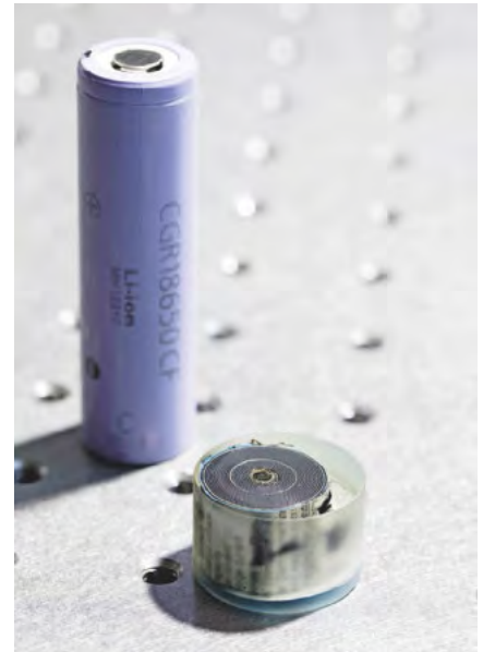
Die Bedeutung von Batterien als Energiespeicher wächst, etwa in elektronischen Geräten. Im Bild: ein aufgeschnittener Lithium-Ionen-Akku.
