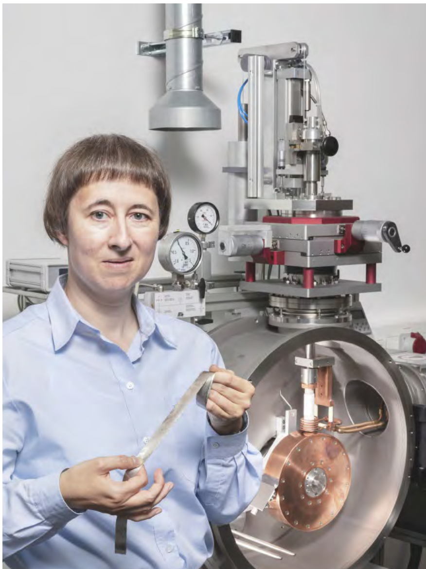
Dagmar Goll ist neuen magnetischen Werkstoffen mit besonderen Eigenschaften auf der Spur. Das Metallband, das sie in den Händen hält, wurde an der Schmelzspinnanlage im Hintergrund gefertigt.
